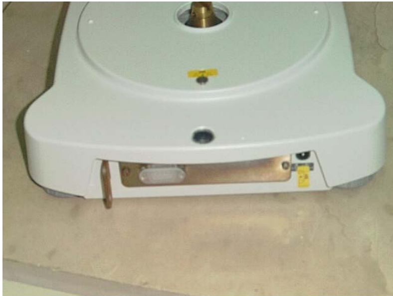
Slika 5. Zaštita od neovlaštenog pristupa i ovjera za vage tipa: PB...-S, PB...-L i JB...-G
